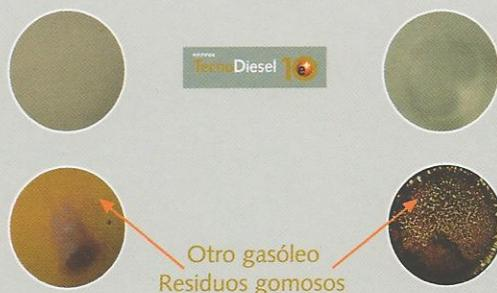
Aspecto de los filtros (0,8 micras) de ensayo estabilidad a la oxidación ASTM D-2274 modificada (PEC - 1093 - C. Oxidación severa: 16 horas, 95°C., borbotado de oxígeno 3 l/h, adición de Cu.)
